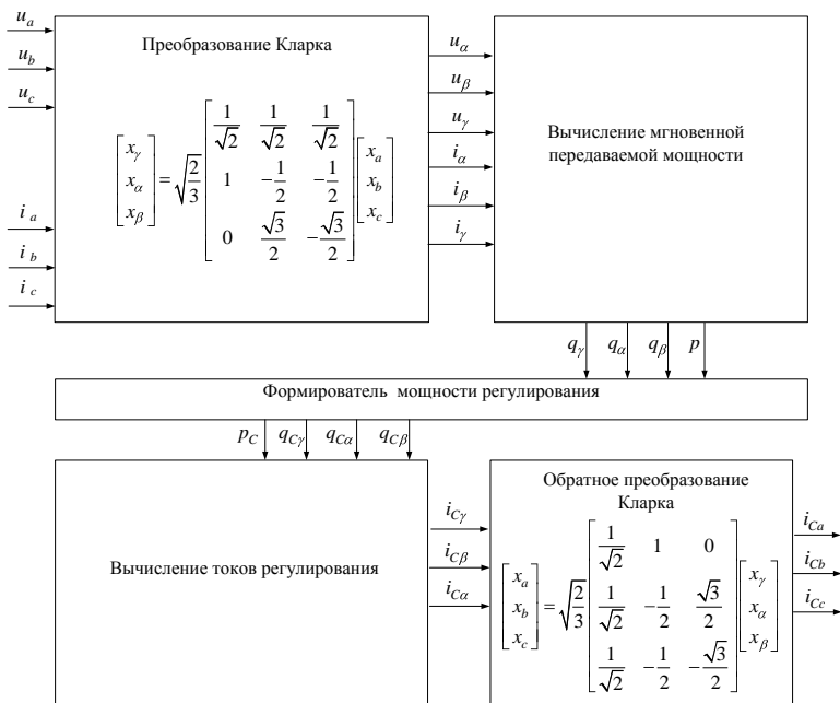
Рис. 20. - Структурная схема системы формирования токов УП
