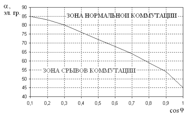
Рис. 14. Зависимость значений критических углов регулирования в режиме понижения напряжения от фазового угла нагрузки
