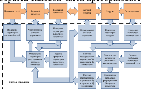
Рис. 35. – Структурная схема силовой части УП на базе UPFC и её системы управления
