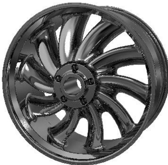
Рис.6. Геометрическая модель литого диска
