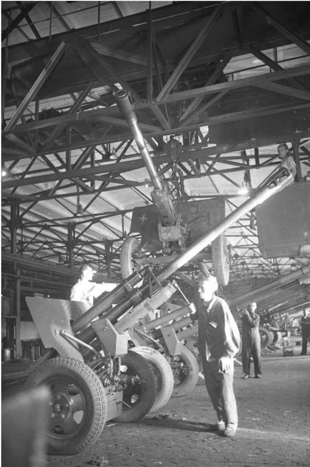
Производство 76,2-мм дивизионных орудий ЗиС-3 на заводе № 92 в Горьком (ныне Нижегородский машзавод), 1942 г. Ученые кафедр ГИИ выполняли ряд исследований по заказу завода. (ЦАНО. Ф.2464. Оп.8. Д.22. Л.30).
